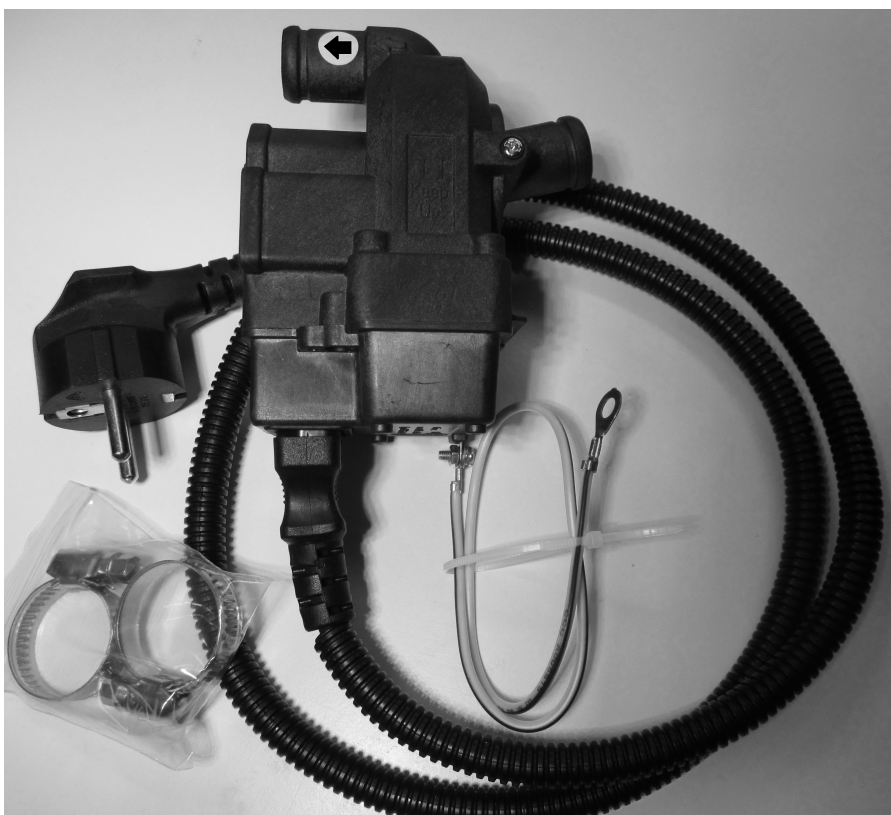
Bilde: Den øverste slangetilkoblingen er varmtvann ut, som spyles ut pga. innebygd sirkulasjonspumpe.
